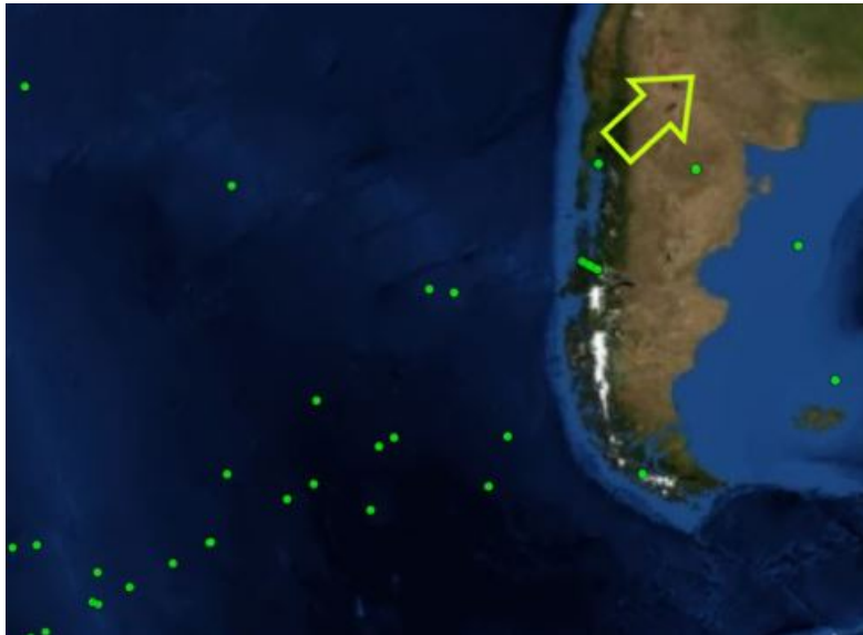
Figura 3. Tránsito de satélites Starlink sobre Puerto Montt a las 21:44 del 20 de octubre de 2020. Con una flecha verde se muestra el rumbo de la formación. El punto verde inmediatamente detrás de la flecha, corresponde al satélite Starlink 1028, sobre la localización de la usuaria.
